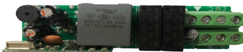
DRE 269A est un récepteur externe waterproof avec une protection classée IP65 (protection contre les poussières et contre les jets d'eau de toutes directions).
